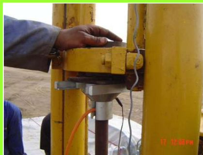
قطعه انتقال نیرو از جک به میله
